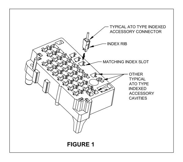
NOTE: THE ATO BLOCK SHOWN IS FOR REFERENCE ONLY. OTHER ATO FUSE BLOCKS MAY LOOK DIFFERENT BUT THE ATO ACCESSORY CAVITIES WILL BE THE SAME IF THE BLOCK IS A FACTORY ATO FUSE BLOCK.
